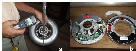
Figura 7. Testes iniciais do sensor de temperatura no laboratório de alta tensão da UFMG e detalhe da arquitetura do sensor Power Donut-2.
