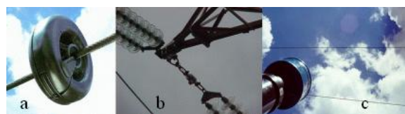
Figura 2. Sensores utilizados para monitorar linhas aéreas em tempo real.
